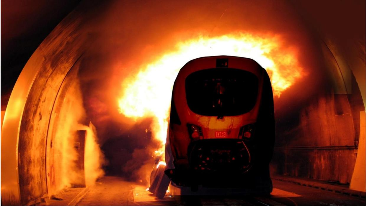
**Bild 7.3.1: Brandversuch eines Zuges im Tunnel**
