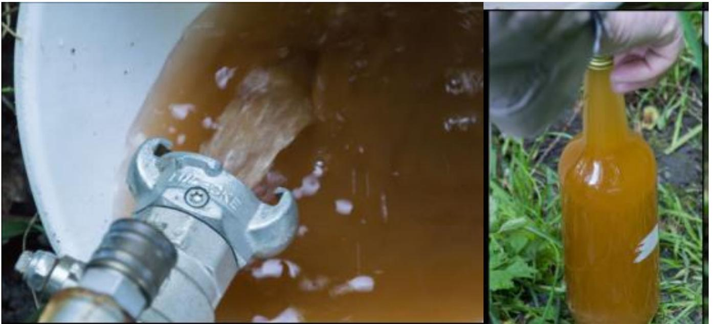
Wasserprobenahme: Ablaufleitung zum Neckar am 14.5.2014:  $139 \text{ mg Fe/l} = 267 \text{ mg Fe(OH)}_3$
