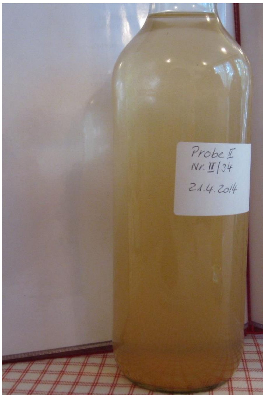
Wasserprobe v. 21.4.2014 aus Zuleitung zu IBr 34: 17 mg Fe/l => 32,5 mg Fe(OH) 3
