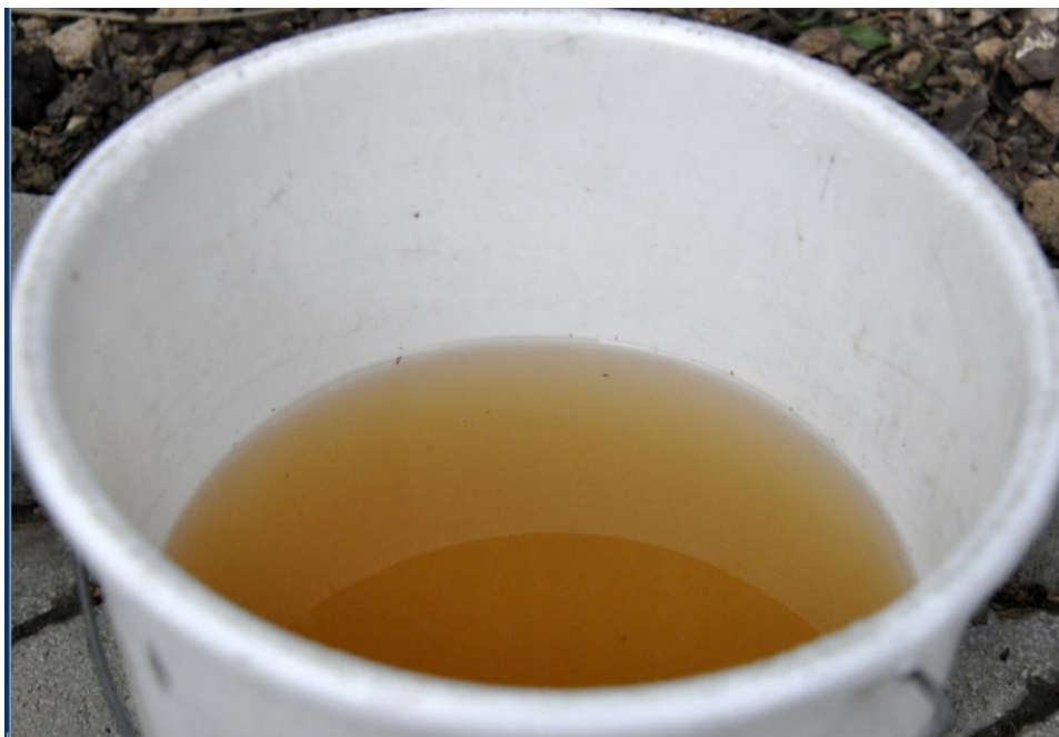
Wasserprobe v. 21.4.2014 aus Zuleitung zu IBr 34: 17 mg Fe/l => 32,5 mg Fe(OH) 3
