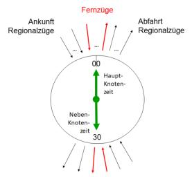
Abb. 1: "Rosette" (schematisch) für Taktverkehr im Halbstundentakt (Beispiel: Schweiz) Zeichnung: W. Hesse
