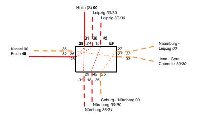
Abb. 3: Lösung für Fernverkehrsknoten Erfurt (30) im D-Takt mit Erhalt der Knoten Nürnberg (30 / 00), Leipzig (30) und Halle/S. (00) – Minuten-Angaben fett: stündlich, Normalschrift: gerade Stunde, kursiv: ungerade Stunde (Zeichnung: W. Hesse)
