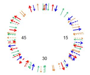
Abb. 4: Der Halbstundentakt verbessert die Lage im nicht systematischen Fahrplan nur beschränkt. Das zeigt die Rosette für Stuttgart 21 laut "Zielfahrplan 2030" des BMVI (Ankünfte und Abfahrten im Uhrzeigersinn, blau/grün: Fern-/Nahverkehr in W-O-Richtung, rot/orange: Fern-/Nahverkehr in O-W-Richtung, 2-Std.-Takte gestrichelt) Zeichnung: W. Hesse
