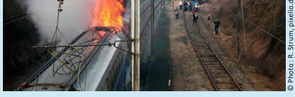
Test d'incendie sur un train voyageurs Brunsberg Tunnel / Suède 2012 : A peine 7 minutes après allumage le train entier a pris feu
